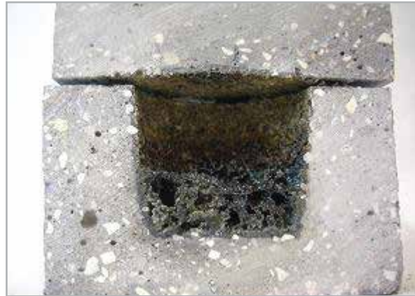
[Alfranjet Clean 30. Ataque de álcalis / Alkali attack. T: 1.000°C / 1.832°F]
