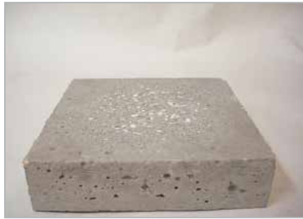
[Alfranjet Clean 30. Ataque de abrasión / Abrasion loss. T: 816°C / 1500°F - 3,0 cm 3 ]
