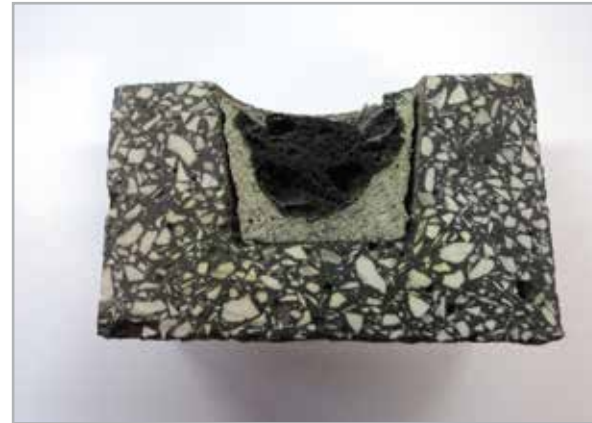
[Clean 40. Ataque de álcalis / Alkali attack. T: 1.000°C / 1.832°F]
