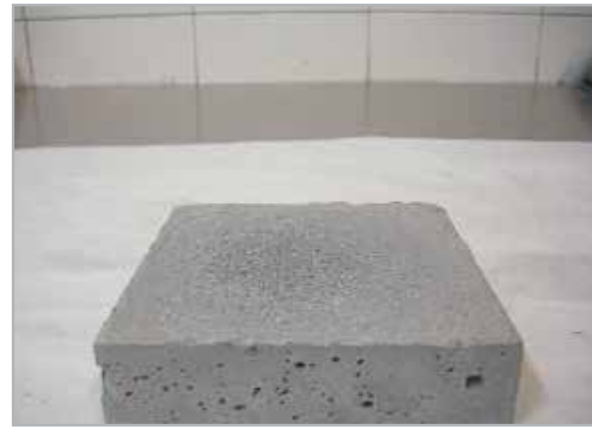
[Clean 40. Ataque de abrasión / Abrasion loss. T: 816°C / 1500°F - 3,5 cm 3 ]
