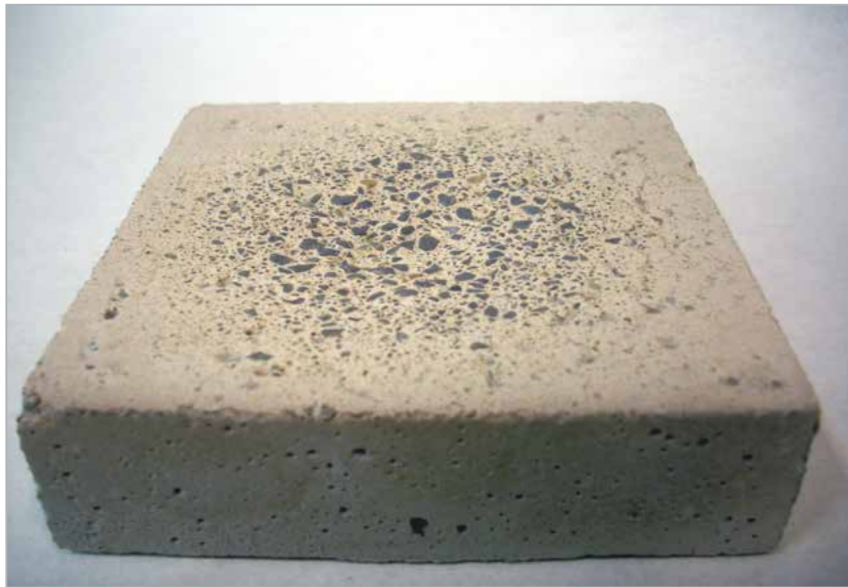
[Alfranjet DRYTECH 70. Ataque de abrasión / Abrasion loss. T: 816°C / 1500°F - 4,5 cm 3 .]
